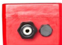
Pressacavo con inserto Diametro del cavo: 5,5 - 8 mm
